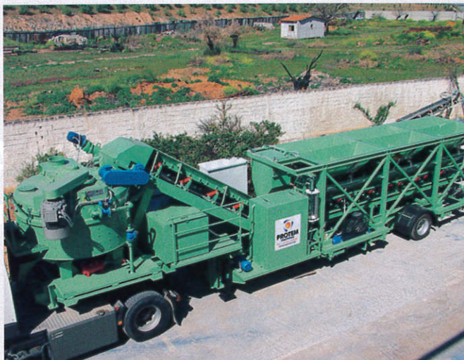
Αυτόνομο και πλήρως κινητό συγκρότημα παραγωγής ετοιμού σκυροδέματος PRM 50/6/50FM της Protém.
