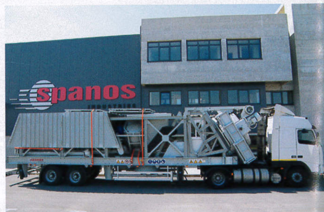
Κινητό συγκρότημα παραγωγής ετοιμού σκυροδέματος Mobispa-1 της Σπανός Οδυσσέας A.B.E.T.E.
